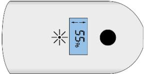
Das LC-Display des OEM Motoric Valve Drive: 24 V Modbus RTU zeigt die Stellposition an. Bei einer Regelanforderung wird die aktuelle Fahrtrichtung im LC-Display durch einen Pfeil dargestellt. Im Fehlerfall wird der zugehörige Fehlercode angezeigt und durch die dauerhaft rot leuchtende LED signalisiert.
